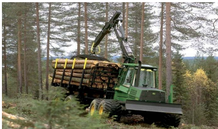
Рис. 3. Окраска лесозаготовительной техники John Deere , черные части окрашены Temadur SC 50 .
