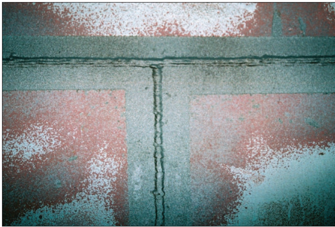
Фото 1 и 2. Ранее окрашенная поверхность, зачищенная до степени Sa2 1/2 . Тщательно выполненная предварительная очистка поверхности обеспечивает превосходную адгезию краски к подложке, что является гарантом ее надежной защиты
