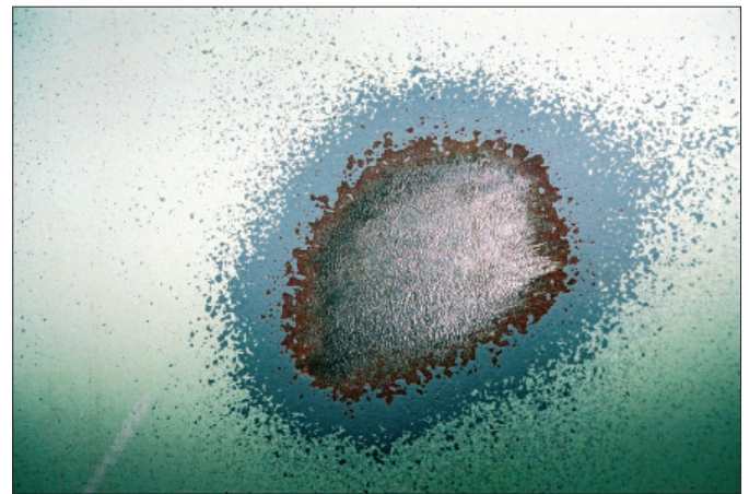
Фото 1 и 2. Ранее окрашенная поверхность, зачищенная до степени Sa2 1/2 . Тщательно выполненная предварительная очистка поверхности обеспечивает превосходную адгезию краски к подложке, что является гарантом ее надежной защиты
